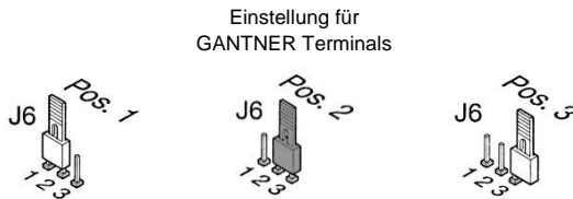
Bild 3.4 - Einstellung der Ausgangsspannung mit Jumper J6
