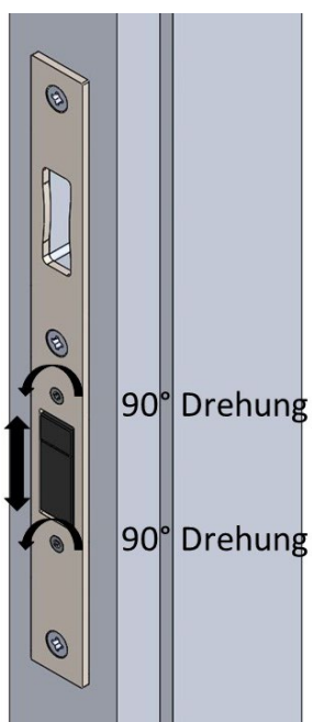
Bild 3.10 – Einstellung der Höhe für die Riegeleinführung
