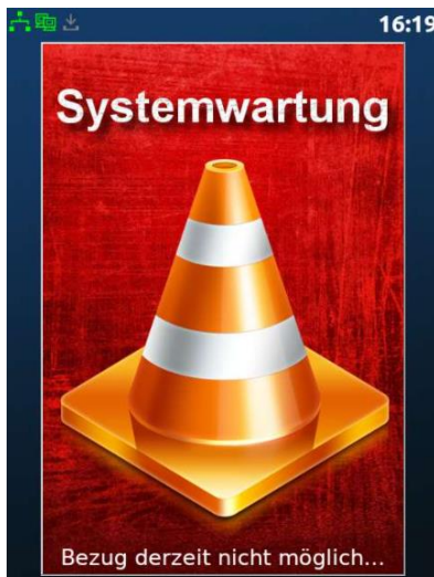
Bild 5.17 – Wartungsanzeige am Display des GV6.1300
