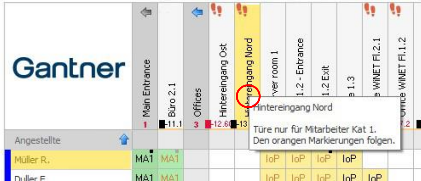
Bild 5.15 - Türinformationen für die Tür "Hintereingang Nord"
